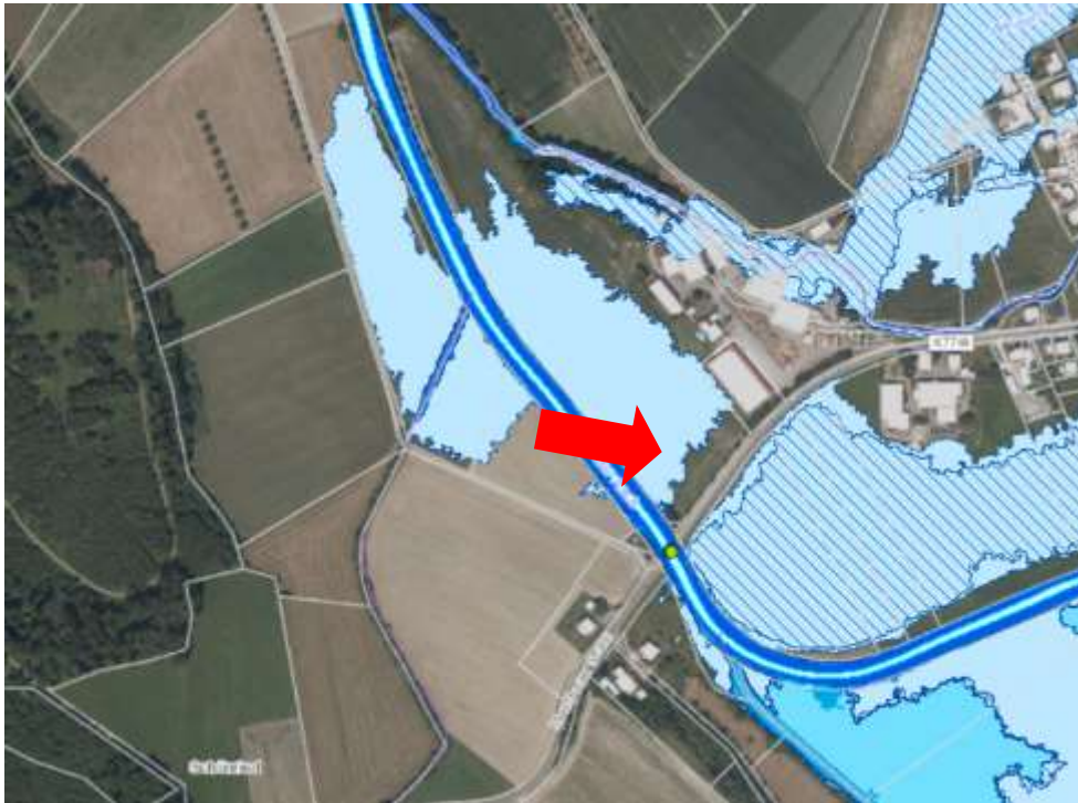
Überflutungsflächen des HQ extrem (Quelle: LUBW)
